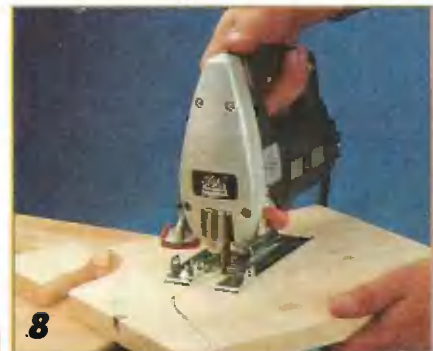
Лекальный контур обвязки дверной рамы лучше выпилить электроробзиком.
