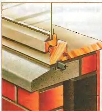
Рис. 1. У этой конструкции окна наружный подоконник является частью оконного откоса. При желании облицевать карниз клинкерными плитками необходимо подготовить под них основу, срубив поврежденный слой. Плитки крепят на клею.
