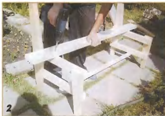
Сборка на саморезах правой ножки скамьи из подготовленных деталей (левая на фото — вдали).
