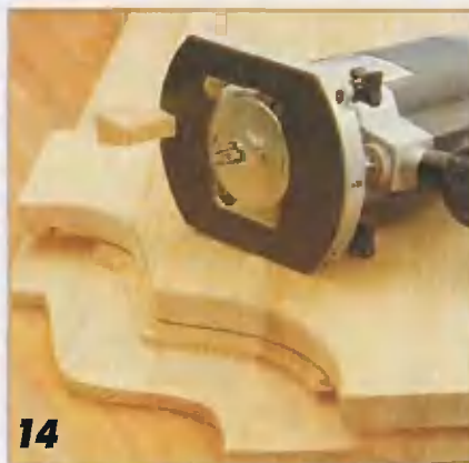
14 Чтобы предотвратить заваливание фрезы, к подошве фрезера можно прикрепить деревянный направляющий брусок.
