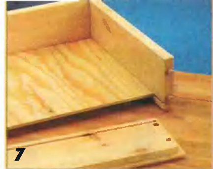
Здесь показана конструкция выдвигного ящика. В боковых и передней стенках выбран паз, в который сзади вставляется днище.
