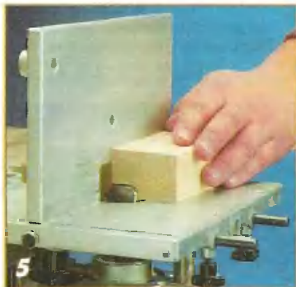
Так получается декоративный профиль раскладок 8 и 9: сначала фрезой в рейке выбирают «выкружку», затем раскладку переворачивают узкой стороной вверх и профилируют.
