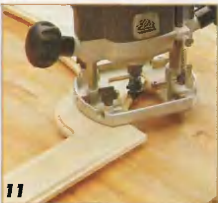
11 С помощью фасонной фрезы с упорным подшипником в наружных и внутренних кромках рам делают фигурные выборки — «выкружки».
