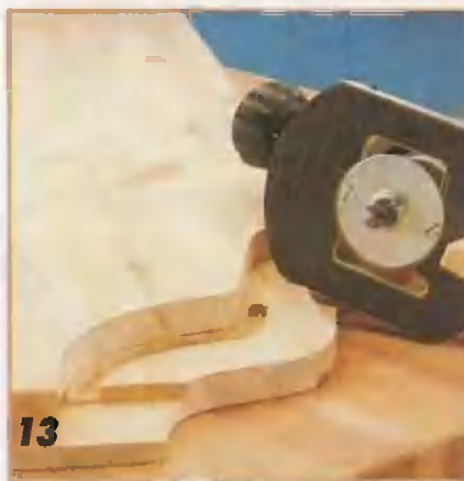
13 Для лекального фрезерования нужен шаблон, который будет направлять движение копировальной втулки. Глубину фрезерования определяют опытным путем.
