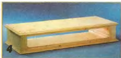
Полностью собранная на нагелях и склеенная цокольная тумба. Детали 17 предотвращают выпадение выдвинутого ящика.
