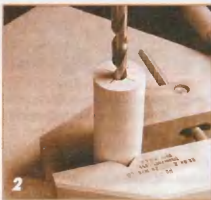
На торцах цилиндра А определяют центр и сверлят глухие отверстия \varnothing 12 и глубиной 12 мм под ручки.
