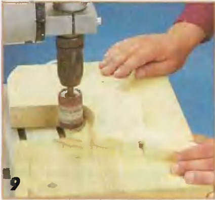
9 Зажав в патроне дрели шлифовальную насадку, готовят кромку для профильного фрезерования.
