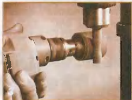
Ручной дрелью обтачивают ручки В на сверлильном станке.
